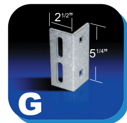
99-002-F Cornière de solive. Utilisée pour fixer les longerons avec les plaques de boulonnage 99-006-F. Elle peut aussi servir de pièce d'appui pour empêcher que les taquets ne s'arrachent.
